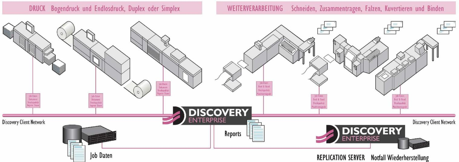
Die Discovery Enterprise Lösung verbindet mehrere Discovery Multiscan Installationen mit einem Discovery Enterprise-Netzwerk, sowie einem Server und liefert umfassende Berichte zur Produktivität und Daten-integrität. Discovery Enterprise kann Druckjobs und Versandaufträge in einem gemischten Druck- und Weiterverarbeitungsprozess überwachen und zusammen-führen.
